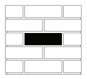
SLEEVE FITS INTO 1 BRICK WIDE BY 1 BRICK HIGH CAVITY
