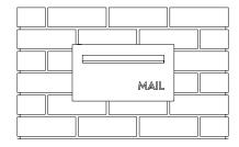
SLEEVE FITS INTO 1.5 BRICK WIDE BY 2 BRICK HIGH CAVITY
