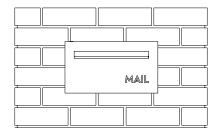
SLEEVE FITS INTO 1.5 BRICK WIDE BY 2 BRICK HIGH CAVITY
